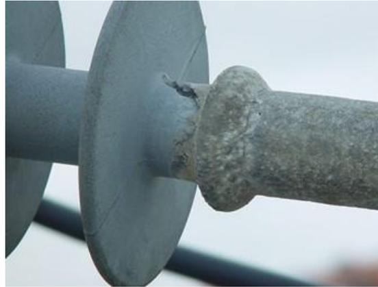
FIGURA 3 - Erosão em um isolador bastão composto.
