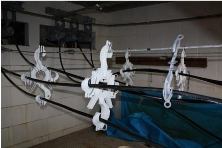
FIGURA 4 - Arranjo experimental do ensaio de compatibilidade dielétrica
