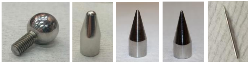
FIGURA 1 – Eletrodos de diferentes diâmetros usados nos experimentos. Esfera de 12,7mm, eletrodos com ponta de diâmetro de 3mm, 0,8mm e 0,6mm e agulha de 0,12mm de diâmetro.
