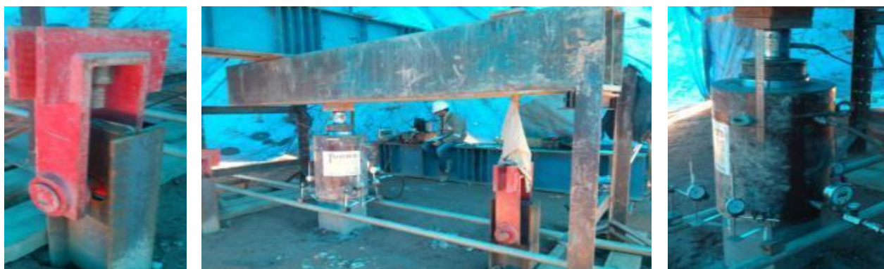
Figura 2 - Ensaio de Prova de Carga Estática na estaca EC-148
