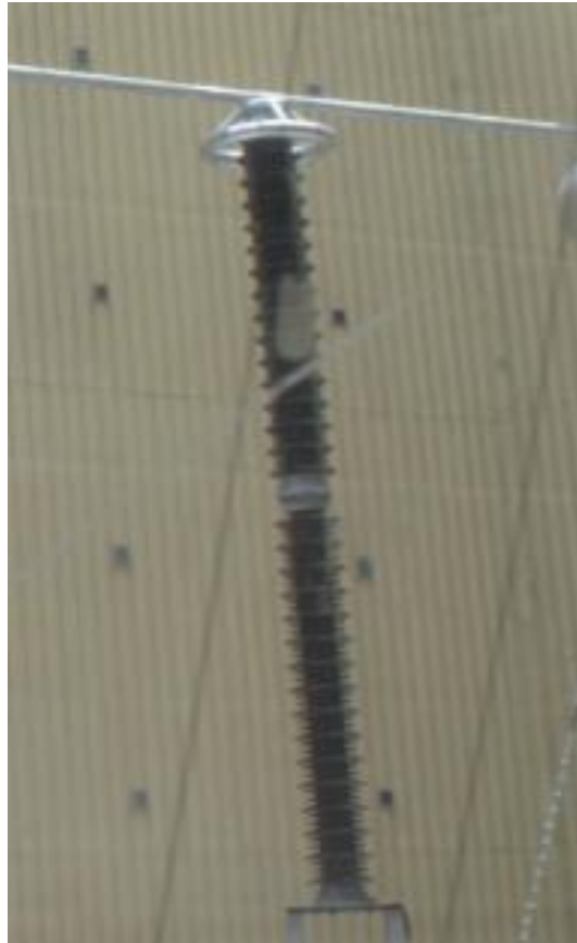
Figura 6 – Isolador montado para teste
