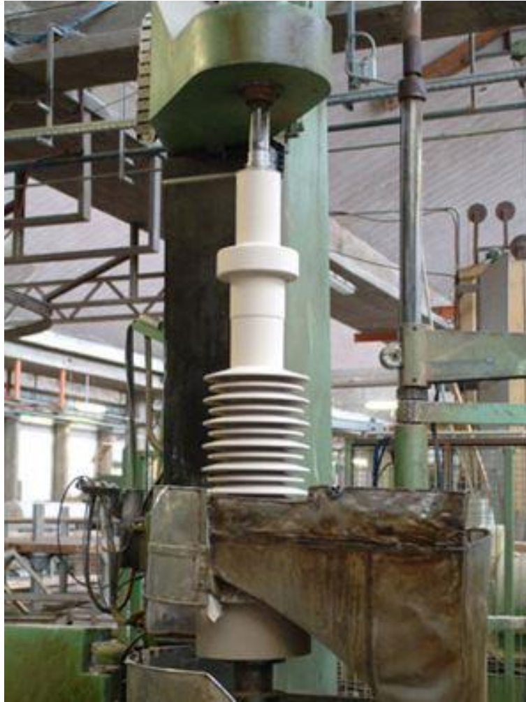
FIGURA 4 – Exemplo de torneamento de um isolador de núcleo sólido
