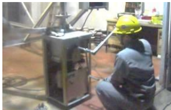
Figura 5 – Tomada de força manual para avaliação do torque máximo.
