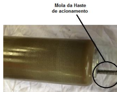
FIGURA 7 – Detalhe da mola do isolador da haste de acionamento
