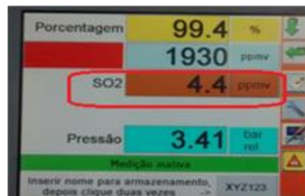
FIGURA 14 – Tela do medidor portátil com a indicação de SO 2
