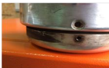
FIGURA 15 – Fotos após a abertura da chave seletora de barra indicando a ocorrência de DPs
