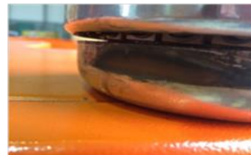
FIGURA 15 – Fotos após a abertura da chave seletora de barra indicando a ocorrência de DPs
