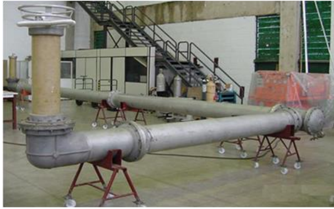
FIGURA 2 – Arranjo de SIG montado no Cepel para realização de pesquisas laboratoriais
