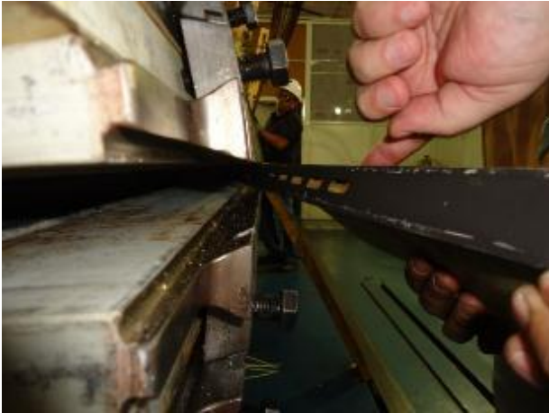
Figura 7 – Isolação do rotor contaminada
