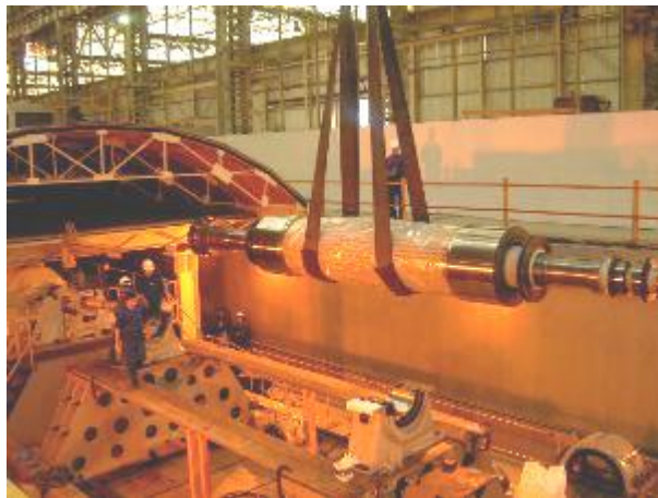
Figura 9 – Rotor no túnel de disparo
