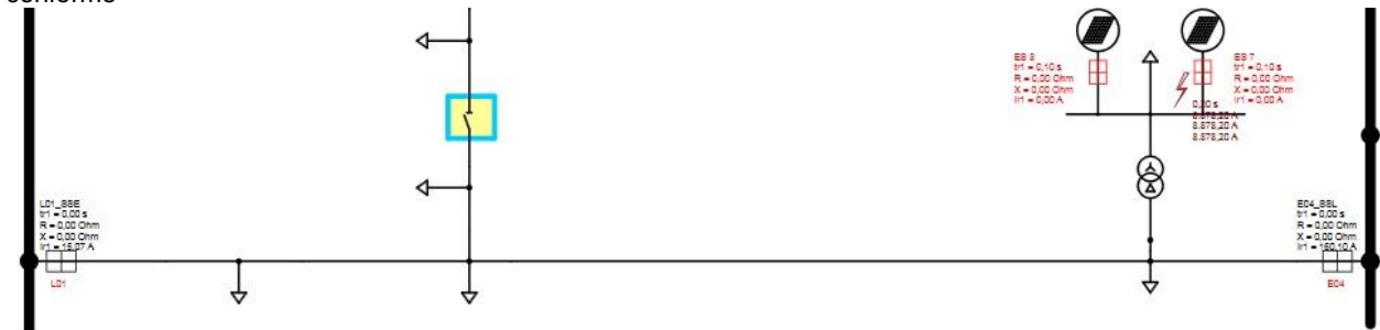
FIGURA 3. Para correção do problema foi adicionado um relé de sobrecorrente no primário do transformador para que esta falta fosse eliminada corretamente.
