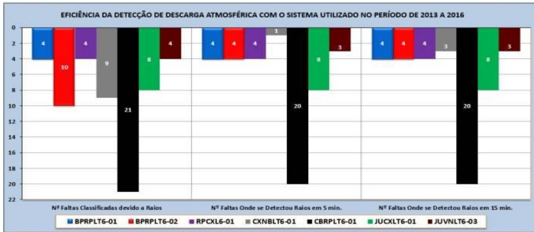
FIGURA 2 – Eficiência da rede de detecção de raios com o sistema utilizado para as LT's (2013 a 2016).
