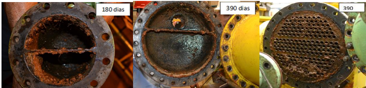
Figura 5. Radiador G4 da UG01 da usina de Sergio Mota, rio Paraná, após 180 (Abril a Outubro) e 390 dias (Abril a Junho do ano seguinte) de exposição à água tratada com radiação UV.
