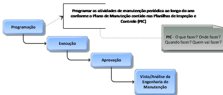
Figura 4 – Processo geral da manutenção periódica
