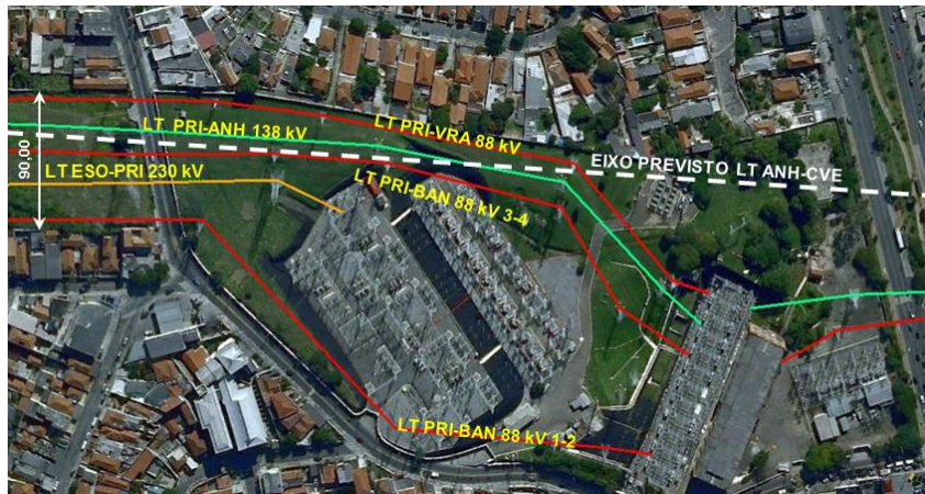
FIGURA 6 – Trecho Interno a SE PIRITUBA (situação existente)
