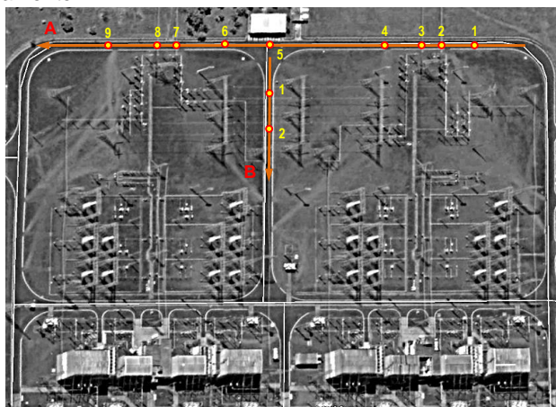
Figura 14 – Pontos de medição - Estação Conversora
