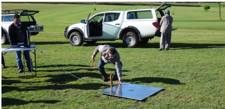
FIGURA 10 - Detalhe do aterramento da placa metálica
