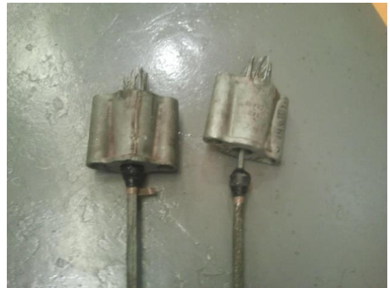
FIGURA 2 – Dispositivo resinado que possibilita ancoragem do condutor ao equipamento de ensaios.
