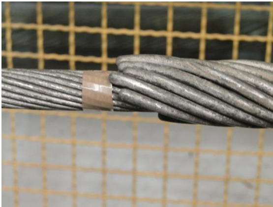
FIGURA 7 – Sem evidências de escorregamento da emenda no lado esquerdo.
