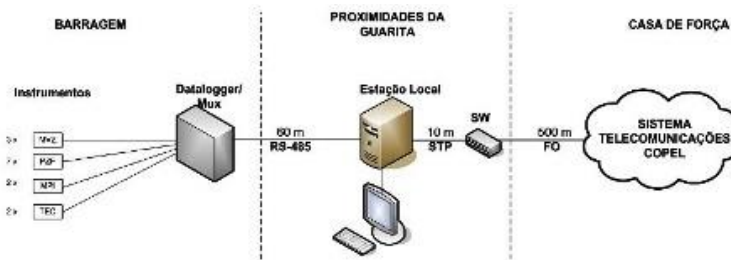
FIGURA 11 – Arquitetura projetada para o sistema automatizado de instrumentação da barragem da UHE GNA.
