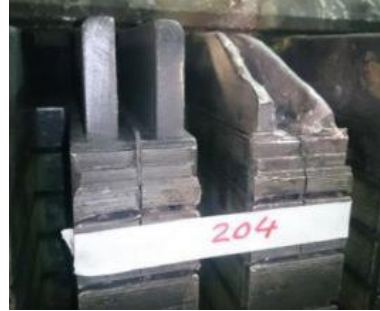
Figura 9 Remoção dos resíduos derretidos sobre a laminação na ranhura 204
