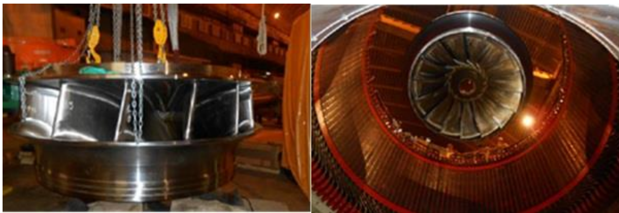
FIGURA 1 - Novo rotor Francis da Usina Hidrelétrica de Ponte de Pedra
