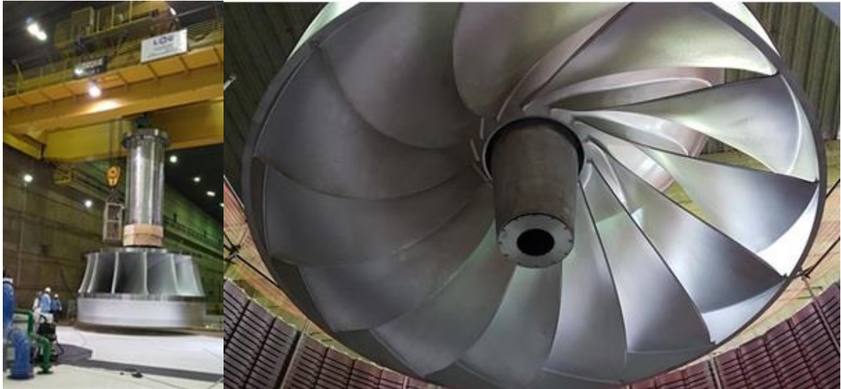
Figura 2 - Novo rotor Francis da Unidade Geradora 4 da Usina Hidrelétrica de Salto Santiago, na área de montagem e passando através do estator
